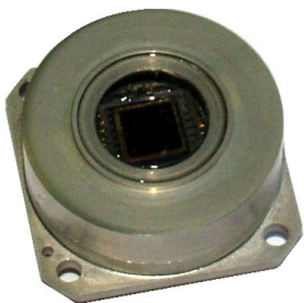
Рис.1. МФПУ 320x256 на InGaAs/InP.
