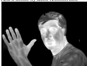
Рис.3. Тепловое изображение, полученное с использованием неохлаждаемого ФПУ формата 320x240, работающего на частоте 50 Гц, и германиевого объектива F/1.
