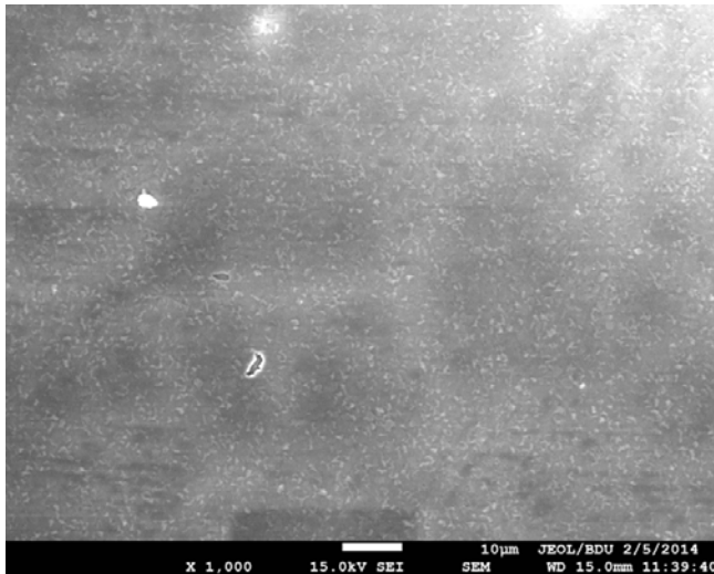
Рис.2. Электронномикроскопический снимок поверхности эпитаксиальных пленок Cd_{1-x}Mn_xTe ( x=0.05 ) ( \times 16000 )
