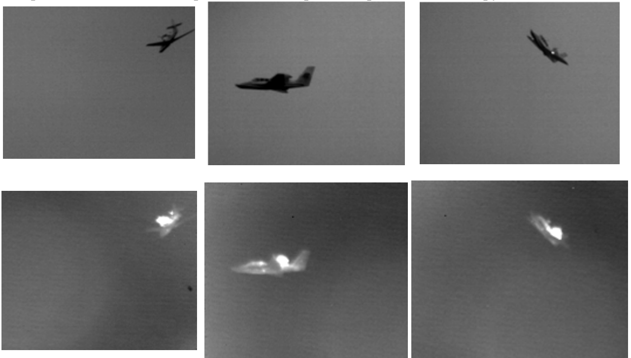
Рисунок 2. Примеры изображений самолета в разных ракурсах в воздухе, зарегистрированных совмещенной теплотелевизионной системой (сверху ТВ диапазон, снизу ИК диапазон).
