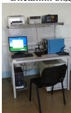
Рисунок 1. Внешний вид автоматизированного стенда для измерения основных параметров МФПУ на основе InGaAs
