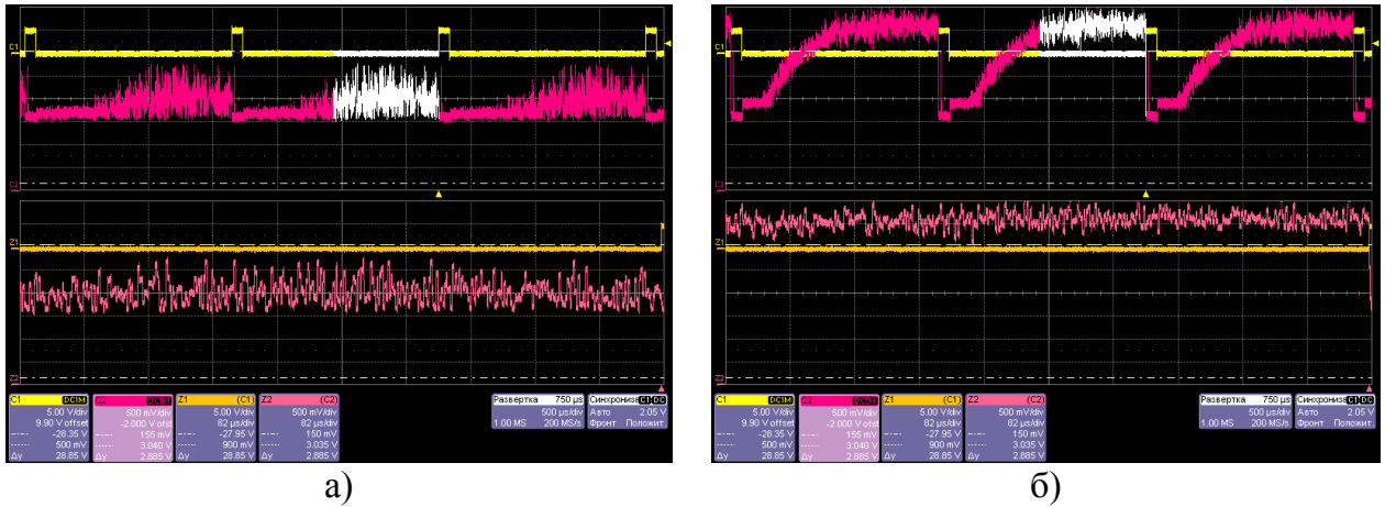
Рис.4 Выходные сигналы: а) в темноте, б) при равномерном освещении; левые части строчных сигналов – считывание строки в процессе ВЗН-накопления, правые – считывание строки после накопления; Кусилителей=35 (Vрегулир.=0,59В).
