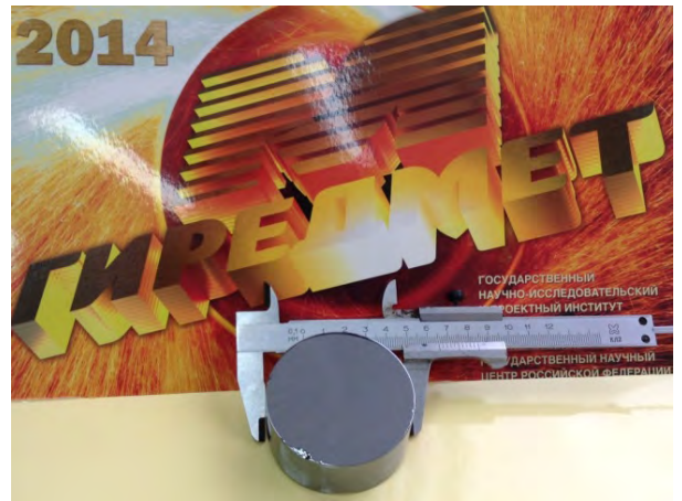
Рисунок 2. Монокристаллы Cd_{0,96}Zn_{0,04}Te Ø65мм, выращенные на затравку
