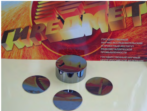
Рисунок 2. Монокристаллы Cd_{0,96}Zn_{0,04}Te Ø65мм, выращенные на затравку
