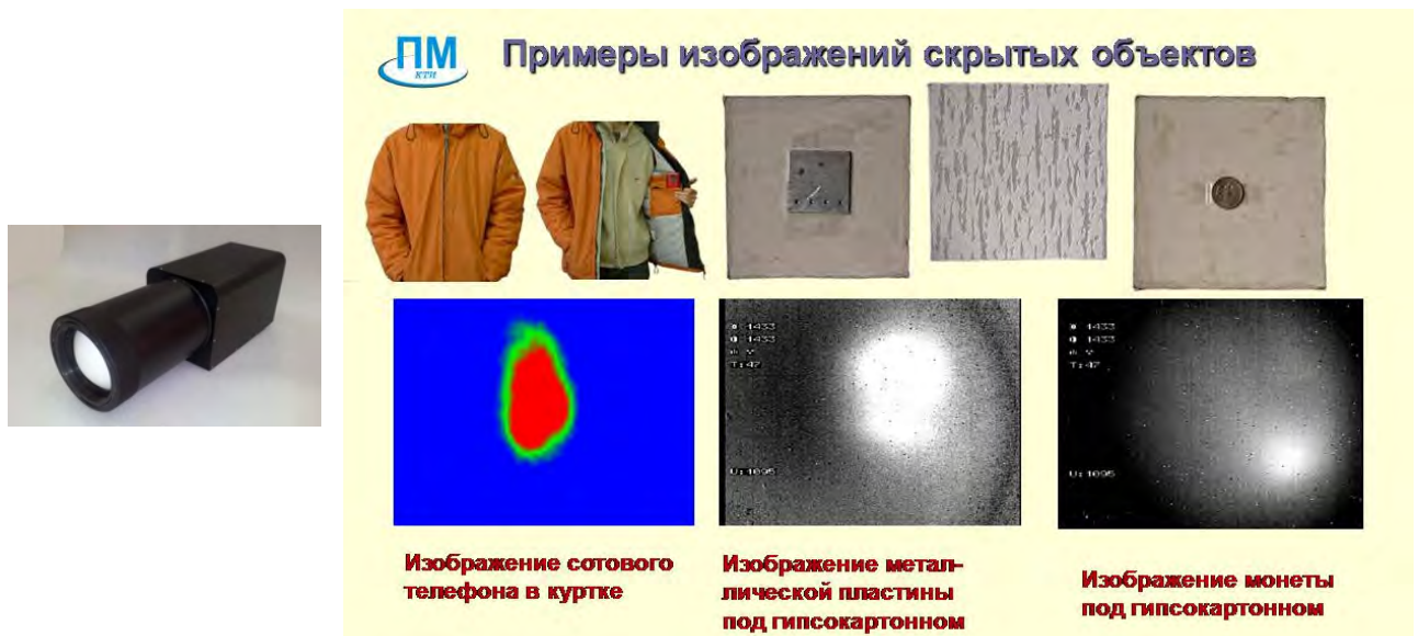
Рис.4. Слева – общий вид визуализатора. Справа – изображения сотового телефона в куртке, металлической пластины и монетки под гипсокартонном, обклеенным обоями.
