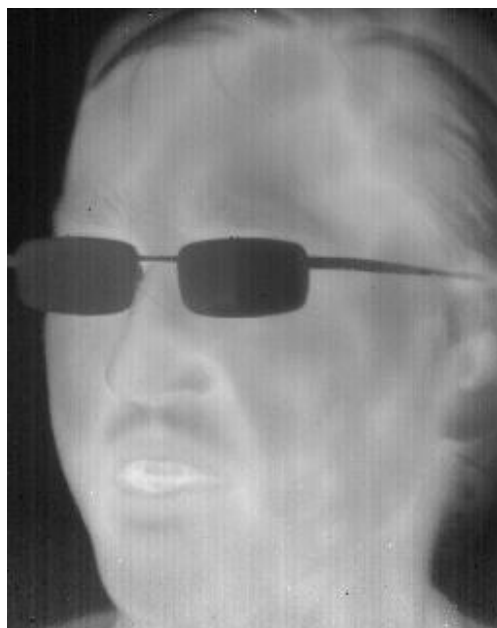
Рисунок 3 – тепловые картины, полученные с помощью ТВК спектрального диапазона 8-12 мкм без применения (слева) и с применением (справа) технологий улучшения изображения
