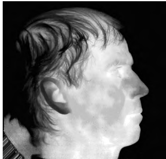
Рис. 2. Гистограмма разности температур эквивалентной шуму МФПУ-Д и пример теплового изображения, полученного с его помощью в составе макета тепловизионного канала.
