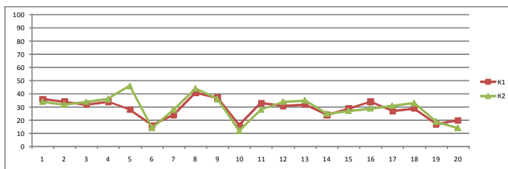
Рис. 1. Зависимость геометрического шума от времени при низком (K1) и высоком (K2) уровне освещения.
