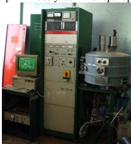
Рис. 1. Автоматизированная установка для напыления просветляющих оптических покрытий
